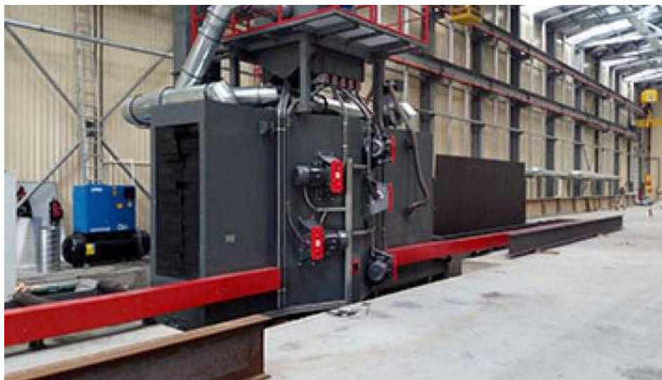
Дробеметная установка Ду.8015 (Поставщик ООО ТД «УралЛитМаш»)
